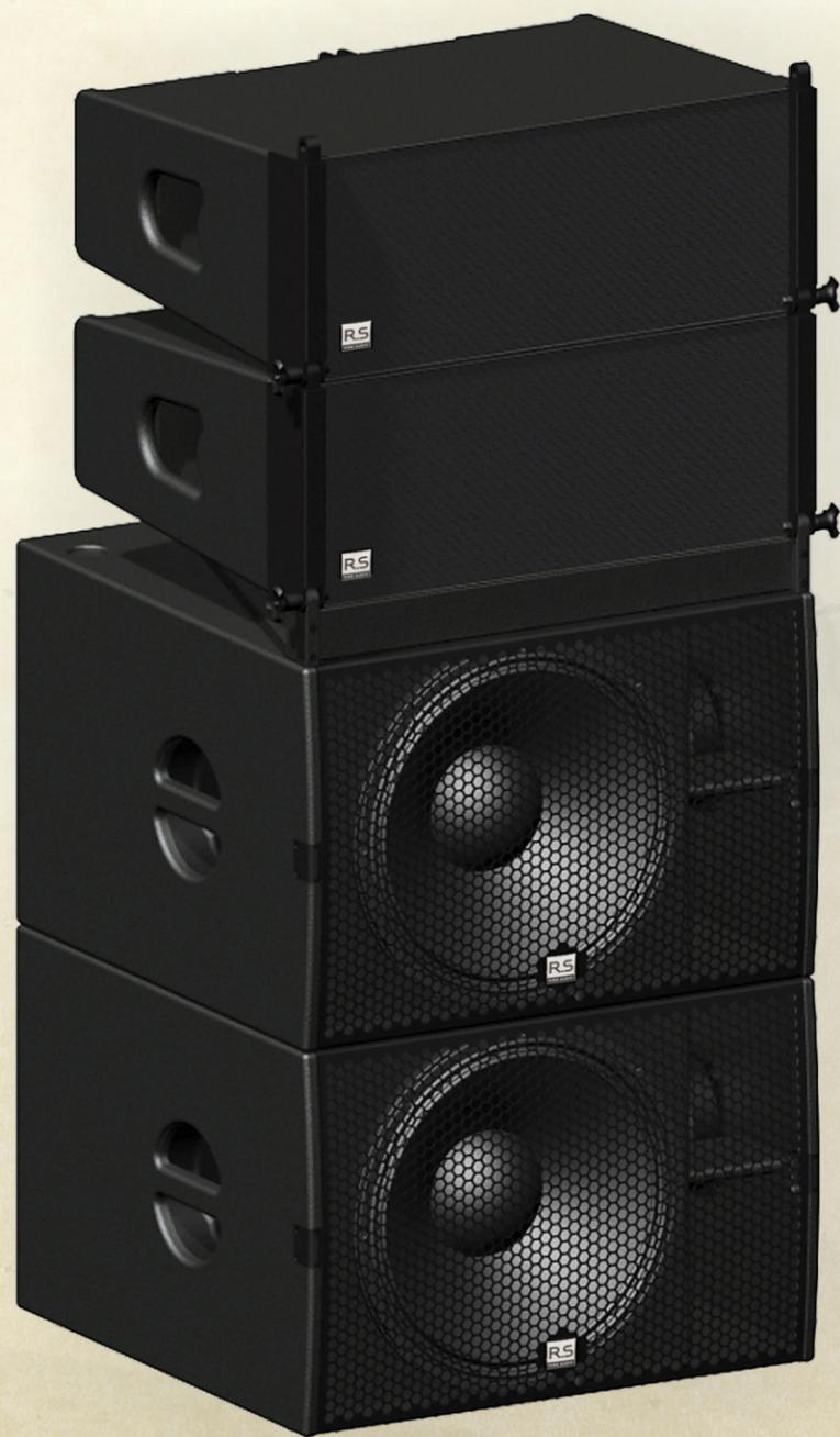
LA KUDO系列线性阵列音箱为高精度线性阵列扬声器系统，它具有较大的动态容量，能提供干净、连续、精确的高品质声音；应用相位校正以及专利线性号角技术，能忠实还原规定范围内频谱信号；LA KUDO系列音箱采用内置分频方式，经过严谨的调试，能充分有效的发挥音箱本身特点，箱体采用高强度桦木夹板，表面采用特殊材料喷涂制作，音箱上装备精密的铝合金吊挂系统，音箱与音箱之间的连接角度可通过吊装件来调节，采用最新人体工程学和机械设计，使整个系统安装快捷及保证了安全。
