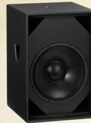
RH415S是一款单15寸超低频音箱,系统同一只3.0"音圈200mm磁钢的15"单元配合单腔倒相式箱体构成。低频数率高、下潜深,具有丰富的弹性和力度,可配合各种全频音箱做大声场的语言和音乐重放。箱体采用优质桦木夹板,喷涂通过SGS环保认证的水性环保漆。
